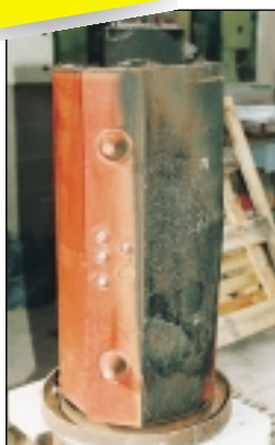
Катушка трансформатора Trihal после испытания F1
