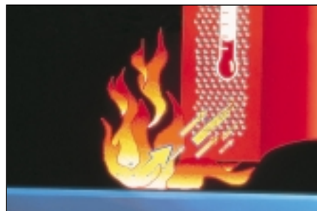
3-й противопожарный эффект: поддержание температуры ниже точки воспламенения
